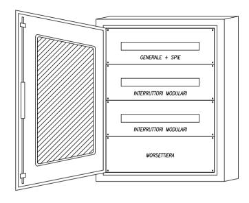
ENTRO CENTRALINO DA ESTERNO IN MATERIALE PLASTICO AUTOESTINGUENTE CON PORTELLA TRASPARENTE CHIUDIBILE A CHIAVE 4x24 MODULI - IP65 MARCA GEWISS, SERIE 46 QP, MODELLO GW46205
